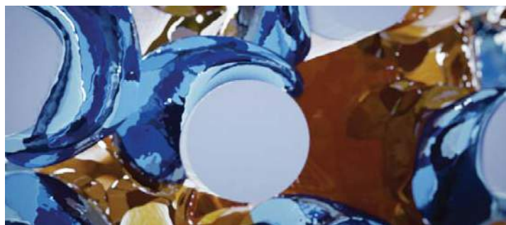
Вигляд волокна everStick зсередини. Окремі скловолокна, полімери PMMA та мономери bis-GMA формують унікальну структуру IPN.
